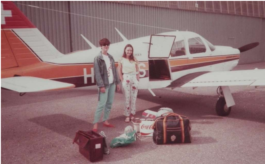
Piper PA 28 Arrow II, Einzieh-Fahrwerk, Verstellpropeller, 200 PS
